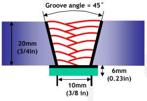
Diameter(mm) : 1.2mm(0.045in) Shielding Gas : 100% CO2 Flow Rate(*l* /min.) : 20~22 Amp./ Volt. : 210/30 Stick-Out(mm) : 20(3/4 in) Pre-Heat(℃) : R.T. ℃(°F) Interpass Temp.(℃) : ≤150°C(302°F) Polarity : DC(+)
